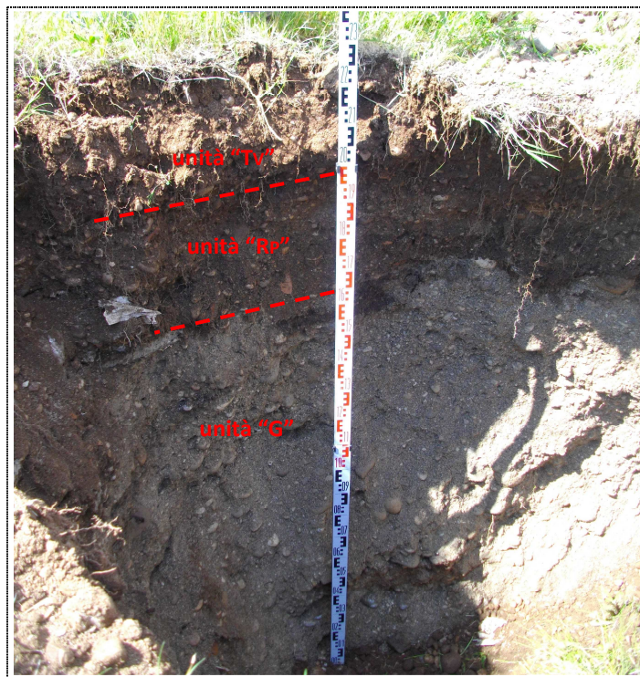
Fig. 6. Particolare di una delle trincee esplorative eseguite.
